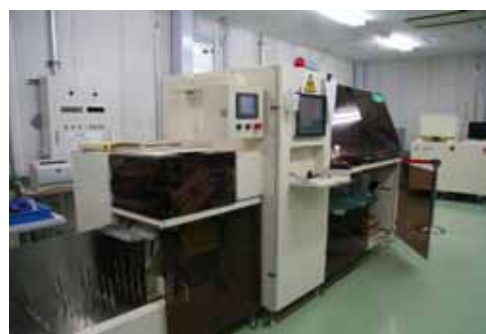
図1 封筒検査のためのスクリーニング部(手前)と分光検査部(右端)
